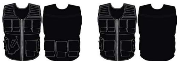
**l.2. Capa Tática:** Confeccionado em ripstop, fitas de acabamento em Nylon, fechamento frontal com Zíper, não contém compartimento para placas balísticas, nem identificações; deve ser sobreposto a capa do colete ordinário; sua composição deve ser adequada a necessidade do efetivo a que se destina.
